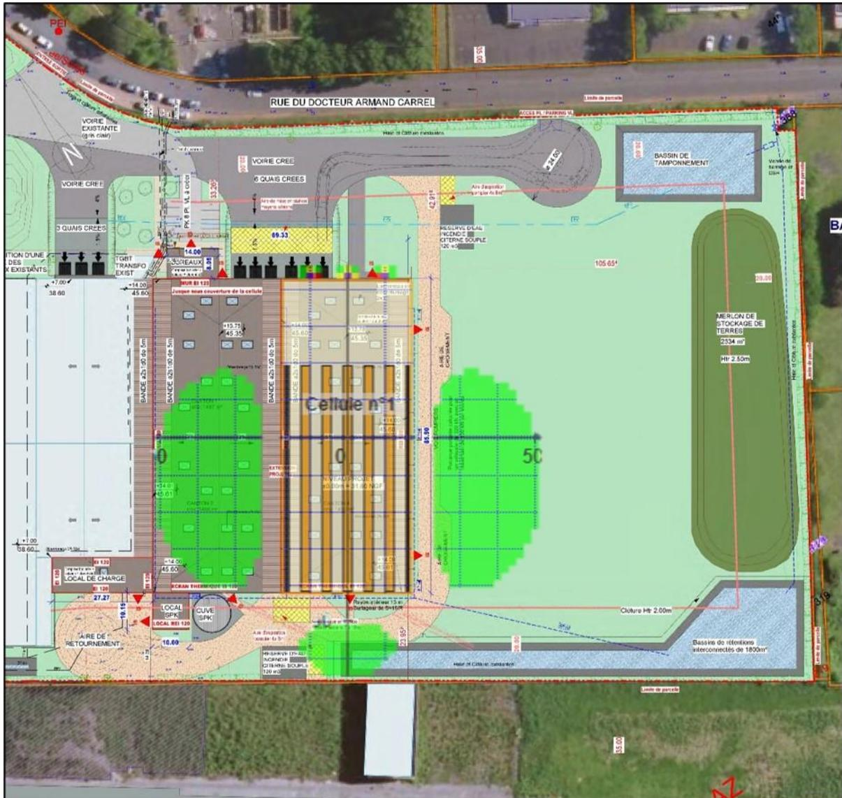
Figure 7 : Projection des effets thermiques dans le cas d'un incendie de produits 1510 stockés en racks traditionnels sur la cellule 2
